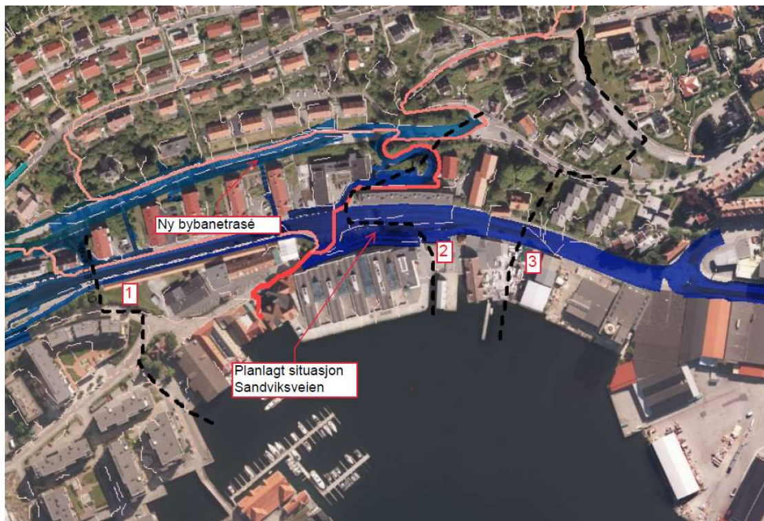
Figur 9. Stikkrenner under Sandviksveien (FV577) mot sjø. 1) OV trase ved Amalie Skrams vei 54 mot Måseskjæret. 2) OV trase mot Ludebryggen (Kristianholmplanen/Sykkelveiprojekt). 3) Alternativ overvannstrase fra Uren mot sjø.
