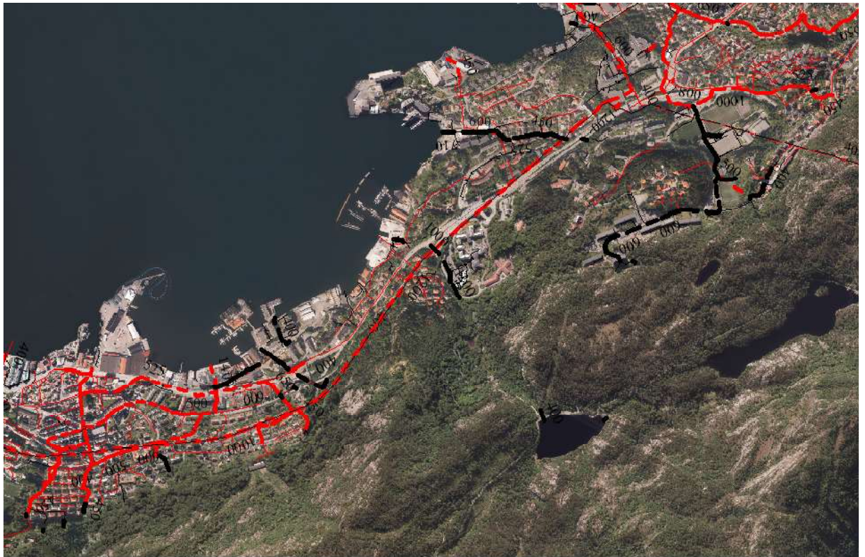
Figur 5: Oversikt hovedsystemer for felles avløp og overvannsledninger
